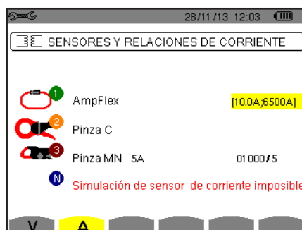
Figura 26: La pantalla Sensores y ratios de corriente en el menú Sensores y ratios
